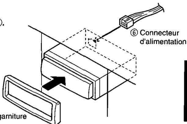
4. Après l'installation, reconnecte l'appareil à la borne négative (-) de la batterie.
