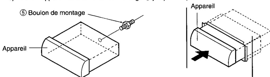
d) Fixer l'arrière de l'appareil sur le véhicule selon l'une des deux méthodes recommandées.
